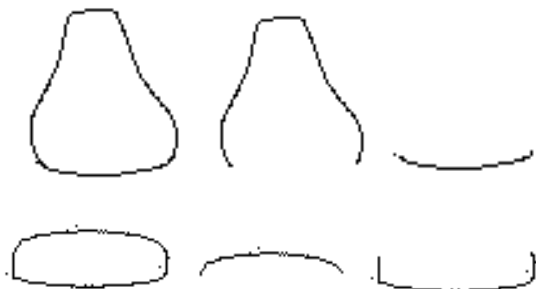
図3：J面による断面及び分割した底・甲部(上)と、M面による断面及び分割した底・甲部(下)
